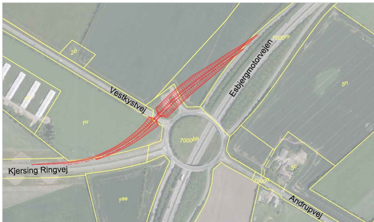
Figur 8-3 Principiel udformning af en shunt uden om fordeleringen ved afkørsel 75.
