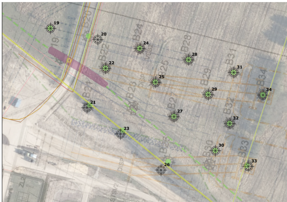
Figur 4-12 Geotekniske borer i byggefelt nord.
