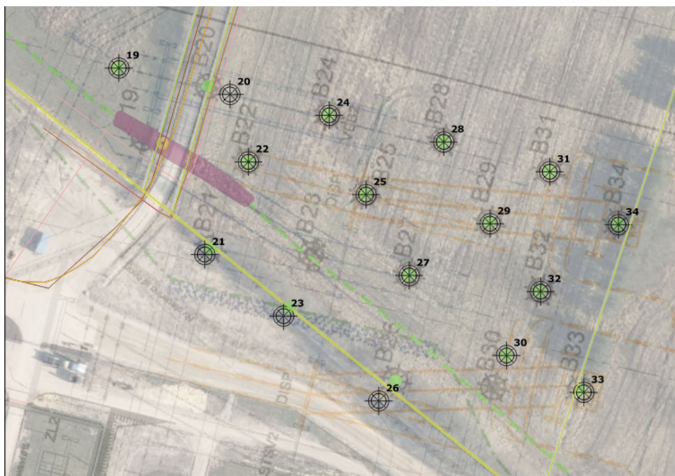
Figur 4-12 Geotekniske borer i byggefelt nord.
